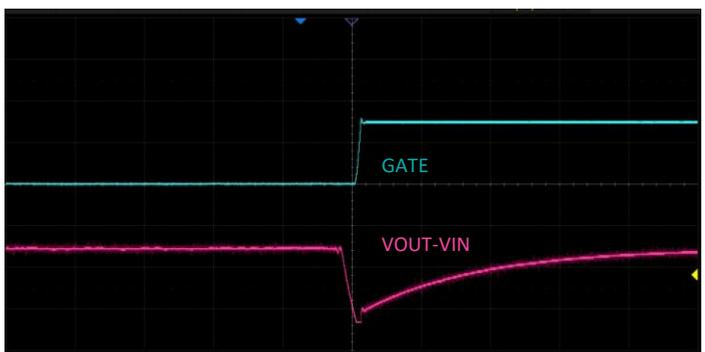
图17 输入比输出高时的反灌保护恢复
