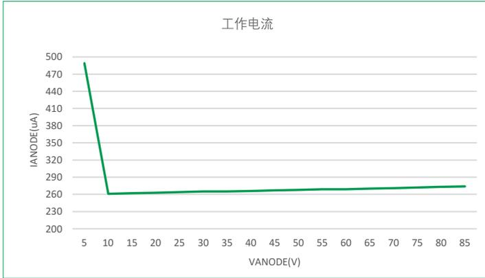
图6 MX74700工作电流与输入电压的关系
