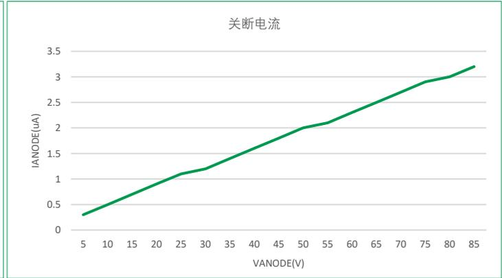
图7 MX74700关断电流与输入电压的关系
